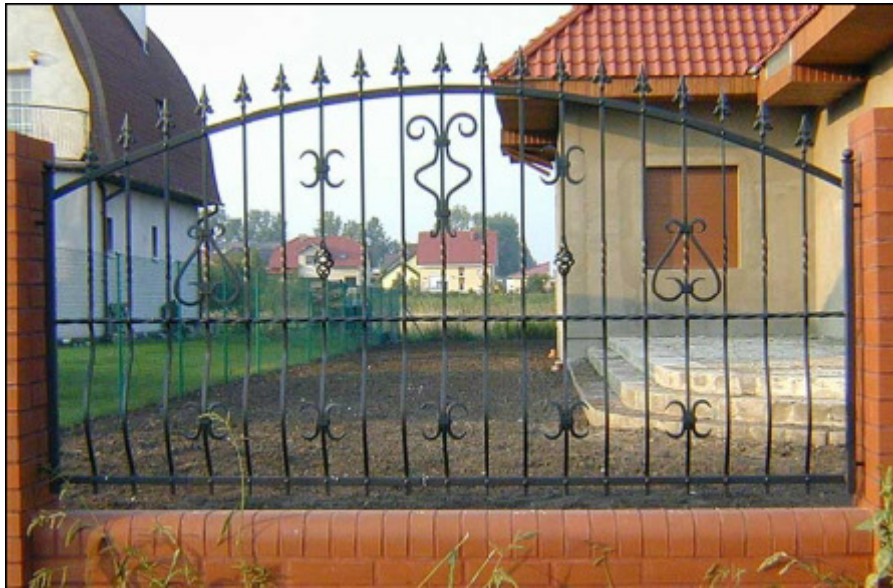
Schmiedeeisernes Zaunfeld / genietet + feuerverzinkt + pulverbeschichtet + patiniert
